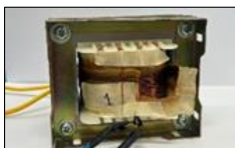
หม้อแปลงไฟฟ้า 1 (ต้นแบบ)
